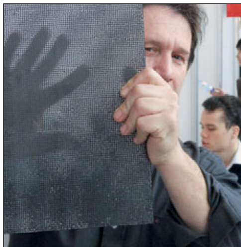
Строительный блок из «прозрачного бетона».
