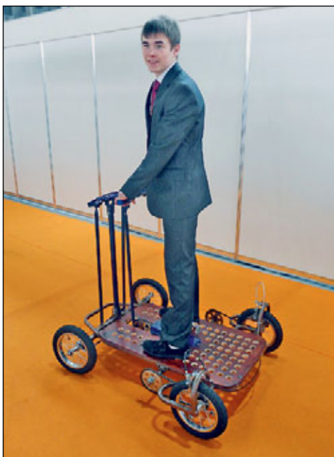
Евгений Шабалин из г. Ирбита со своим четырёхколёсным транспортным средством. Машина снабжена ручным приводом и ножным тормозом.
